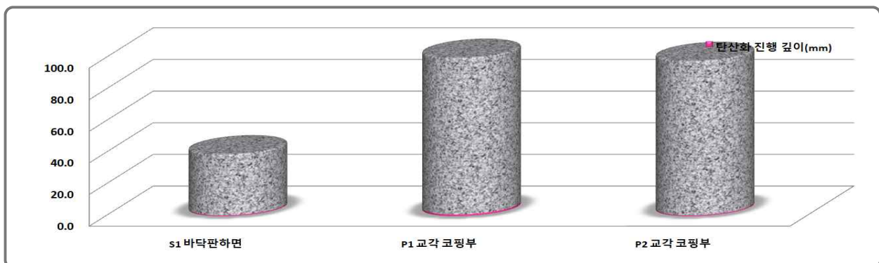
[그림 11.3.6] 탄산화깊이 및 잔여피복두께 측정결과
